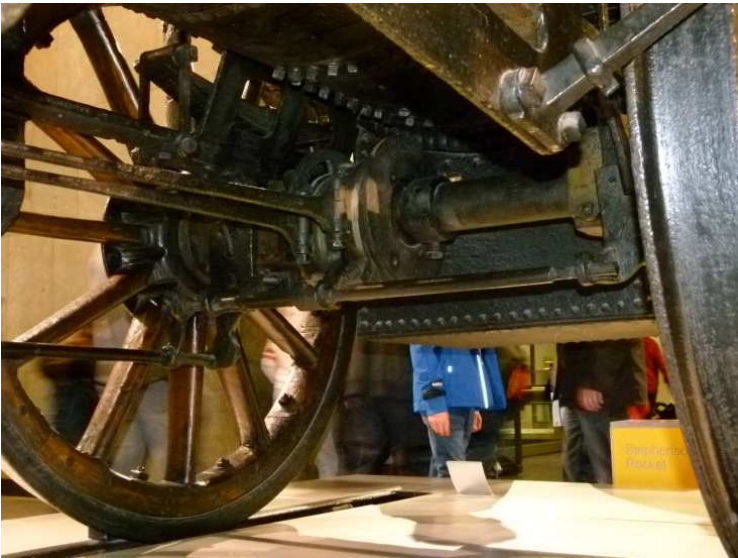
Antriebsachse der originalen Rocket mit den untenliegenden Schiebersteuerungen, umschaltbar Vorwärts / Rückwärts. Man beachte die Antriebsräder aus Holz mit Metallumfassung
