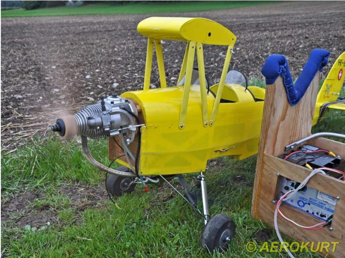
Der RCV Motor beim Einlaufen vor dem Erstflug am 12.09.2014 mit dem neuen Motor
